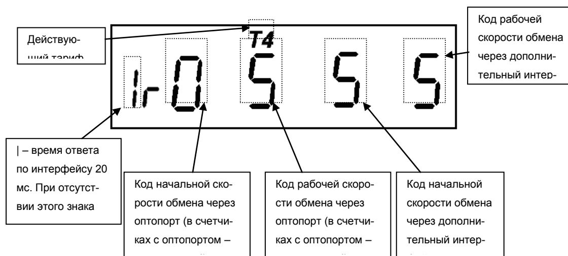
Рисунок 41 – Переключение между группами параметров счетчика
