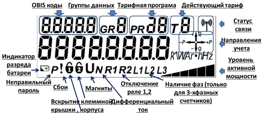
Рисунок 3.6 Информация, выводимая на ЖКИ счетчика исполнения Z.
